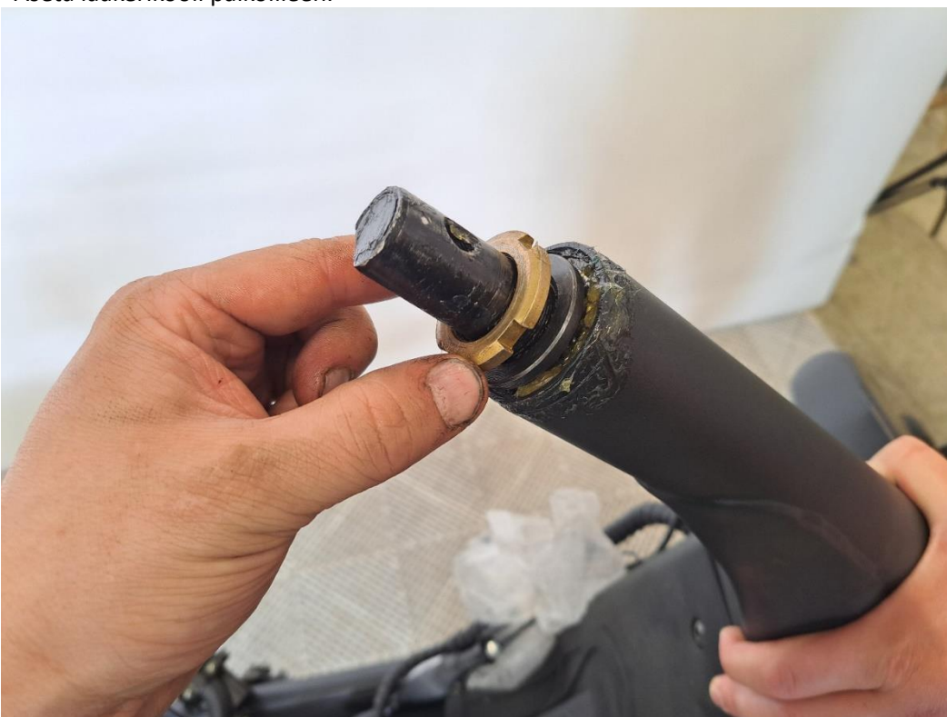
Aseta ohjauslaakereiden kiristysmutteri paikoilleen.
